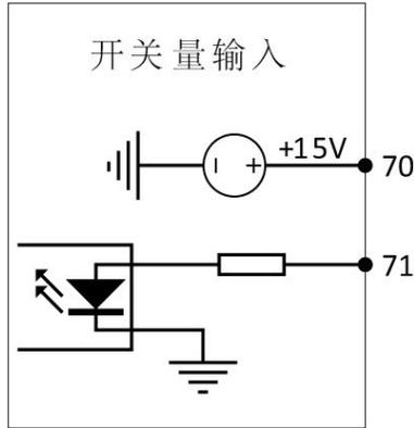
开关量输入模块采用干结点电阻开关信号输入方式，仪表内部配备+15V的工作电源，无需外部供电，可用于监测如故障报警节点、分合闸状态、手车位置、电容补偿柜电容投入状态等。
