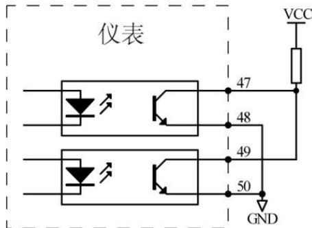
(1). 脉冲常数：5000 imp/kWh(AC380V/5A 量程)、20000 imp/kWh(AC100V/5A 或 AC380V/1A 量程)、80000 imp/kWh (AC100V 1A 量程)，其意义为：当仪表累积 1kWh 时脉冲输出个数为  $N$  (5000、20000、80000) 个，需要强调的是 1kWh 为电能的 2 次侧电能数据，在前端使用 PT、CT 的情况下，相对的  $N$  个脉冲数据对应 1 次侧电能为  $1\text{kWh} \times \text{电压变比 PT} \times \text{电流变比 CT}$ 。
