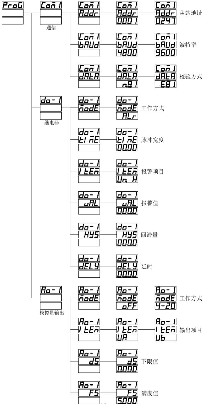
图 4-2 编程设置菜单结构示意图
